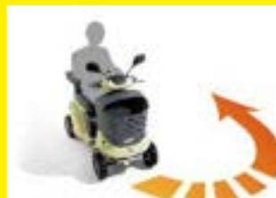
時速4.5kmを超える速度で走行している場合、ハンドルを切った角度に応じて自動的に時速4.5kmまで減速します。
