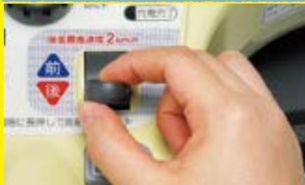
前後進切替えスイッチを使ってバックすることもできます。前に進む場合は切替えスイッチを「前」に、バックする場合は切替えスイッチを「後」に切り替えます。
