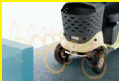
障害物検知サポートは、正対する壁や太いポールなどの前方の障害物を障害物センサーが検知すると、運転者に警告し、車両を減速させることで、安全運転をサポートする機能です。
