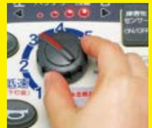
最高速度はハンドルの中央部にあるダイヤルを使い、時速の設定ができます。押し下げる角度でも速度の調整ができます。ひとつで、アクセルとブレーキの操作ができます。
